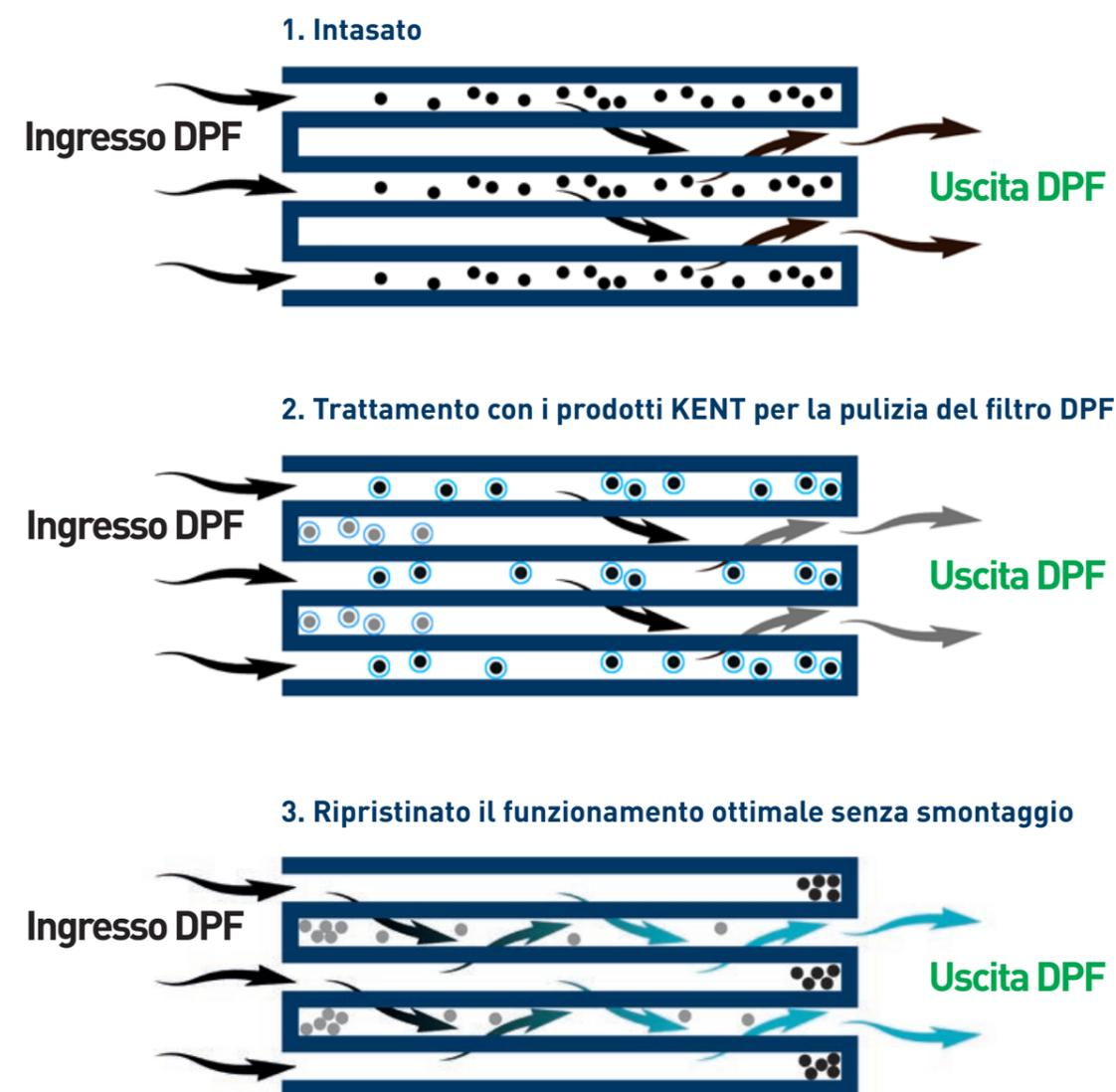
Una autorigenerazione del DPF viene fatta automaticamente ogni qualche centinaio di chilometri. Ma se la temperatura dei gas di scarico non raggiunge un certo valore, il DPF rimane intasato dai depositi di cenere. Inoltre un DPF intasato può creare dei danni al turbocompressore.
